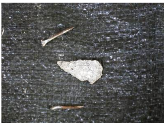
ภาพที่ 3.2.2 - 7 เศษผ้าเพดานและตะปูที่ถูกถอนออกมาจากผ้าเพดาน (ตัดหัวออกและยังไม่ได้ตัดดอก)
