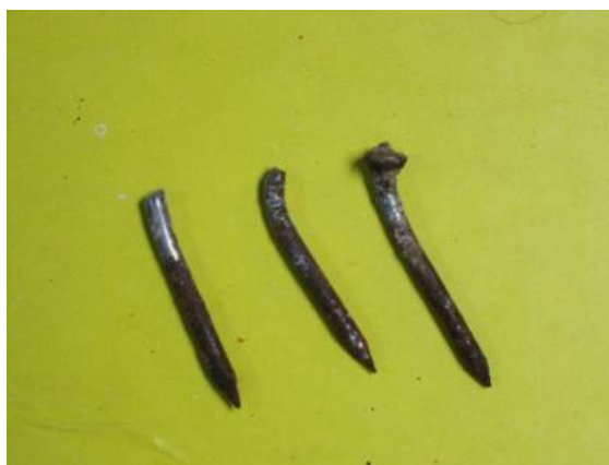
ภาพที่ 3.2.2 - 7 เศษผ้าเพดานและตะปูที่ถูกถอนออกมาจากผ้าเพดาน (ตัดหัวออกและยังไม่ได้ตัดดอก)
