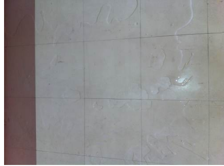
ภาพที่ 3.2.4-1 ราด/ฉีดน้ำลงบนแผ่นกระเบื้องปูพื้น
