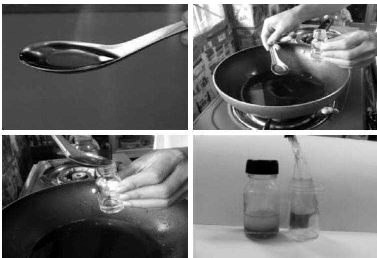
รูปที่ ๕ แสดงวิธีการเก็บตัวอย่างน้ำมันพืชที่ใช้แล้วหลังจากการทอดในแต่ละวัน
